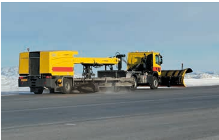
■ Aebi-Schmidt sameyki með flugvallarsóp. Aflvélar þjónusta flugvelli á Íslandi og í Grænlandi með þessi tæki.
