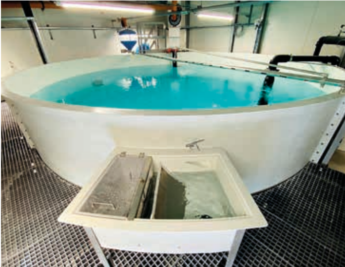
■ Fiskeldisker frá Trefjum, 6 metrar að þvermáli, ásamt fylgibúnaði.
