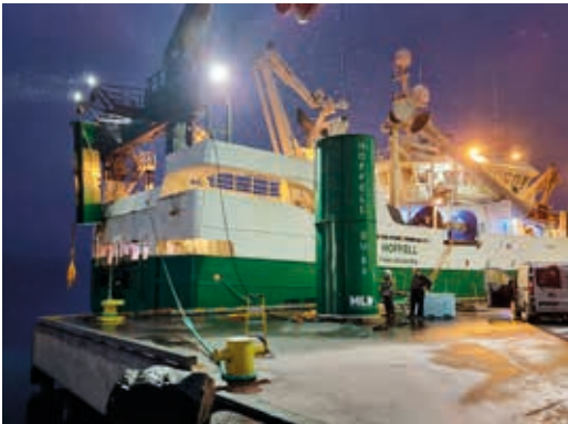
■ Nýir MLD fjarstýranlegir toghlerar settir um borð í Hoffell SU.
