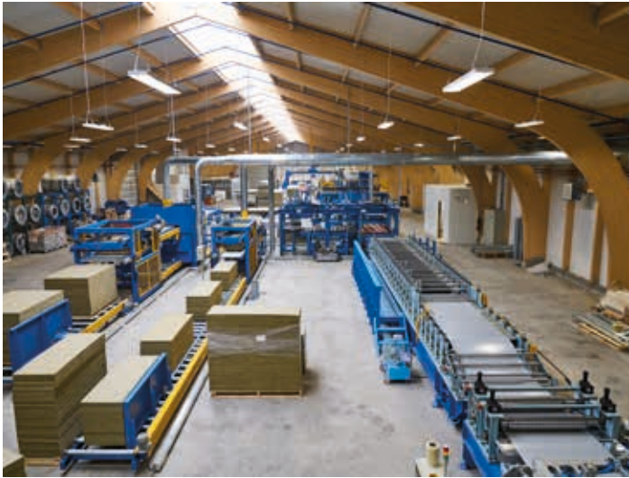
■ Í verksmiðju Límtré Vírnets á Flúðum eru steinullareiningar framleiddar frá grunni.
