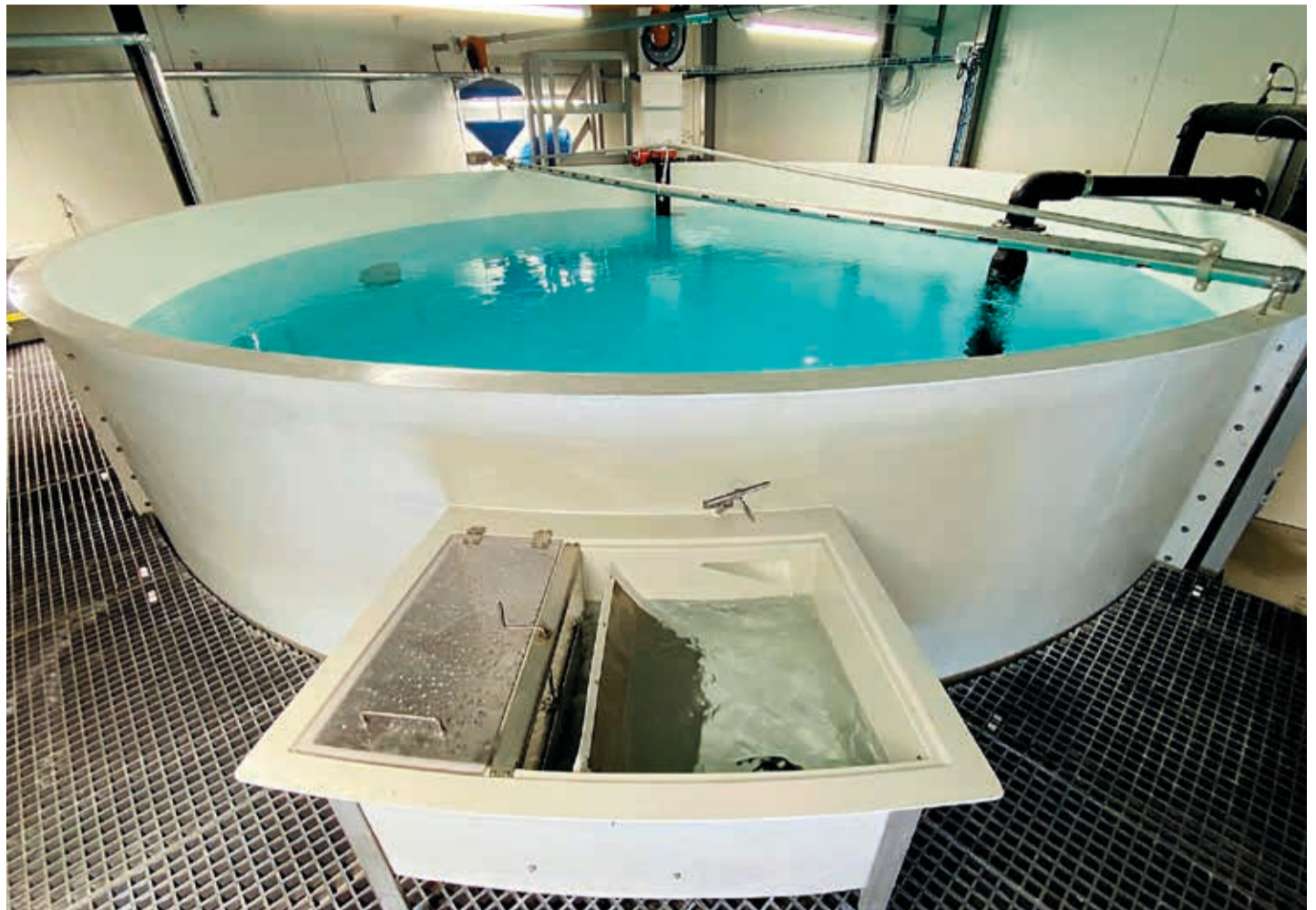
■ Fiskeldisker frá Trefjum, 6 metrar að þvermáli, ásamt fylgibúnaði.
