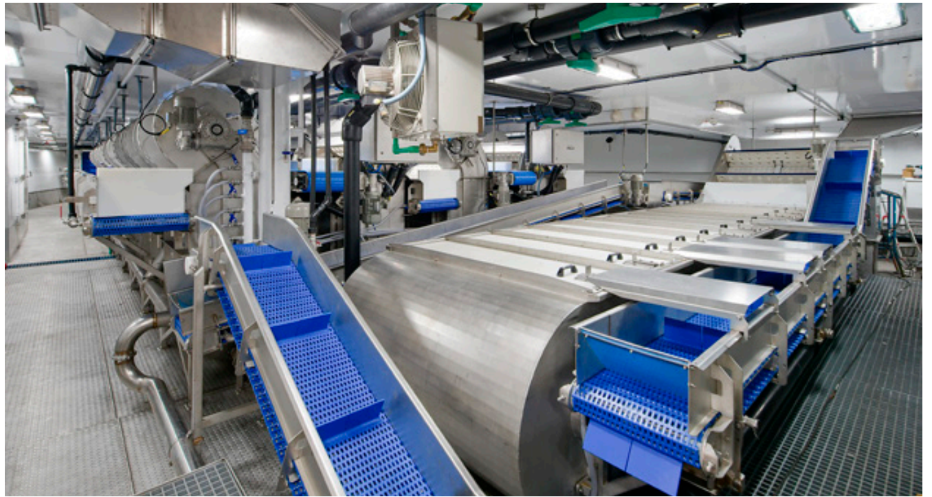
■ Vinnslukerfið á millidekkinu. Þar er aflinn flokkaður og kældur áður en hann fer í ker niður í lest.
