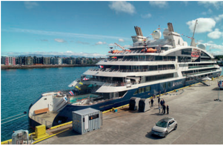
■ Fyrsta háspennutenging við farþegaskip héraðs var tekin í notkun á sjómannadaginn 2022 þegar farþegaskipið Le Bellot var tengt við háspennukerfið á Suðurbakka í Hafnarfjarðarhöfn.
