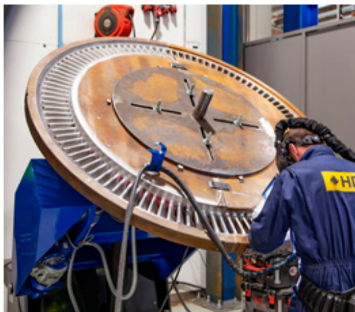
■ Viðgerð á leiðiskóflum fyrir túrbínu úr gufuhverfli.
