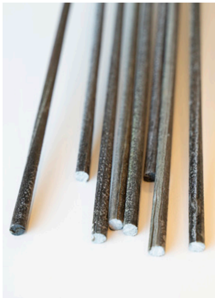
■ Bláþræður er efni úr basalttréfum sem getur komið í stað bendistáls í mannvirkjagerð og er bæði vistvænna efni og léttara, sem gerir það auðveldara í vinnslu. Togstyrkur efnisins er gríðarlegur en fjaðurstuðull þess er hins vegar lægri en bendistáls og þarf að taka tillit til þess í hönnun mannvirkis. Rannsóknir á Bláþræði eru gerðar hjá Háskólanum í Reykjavík.
