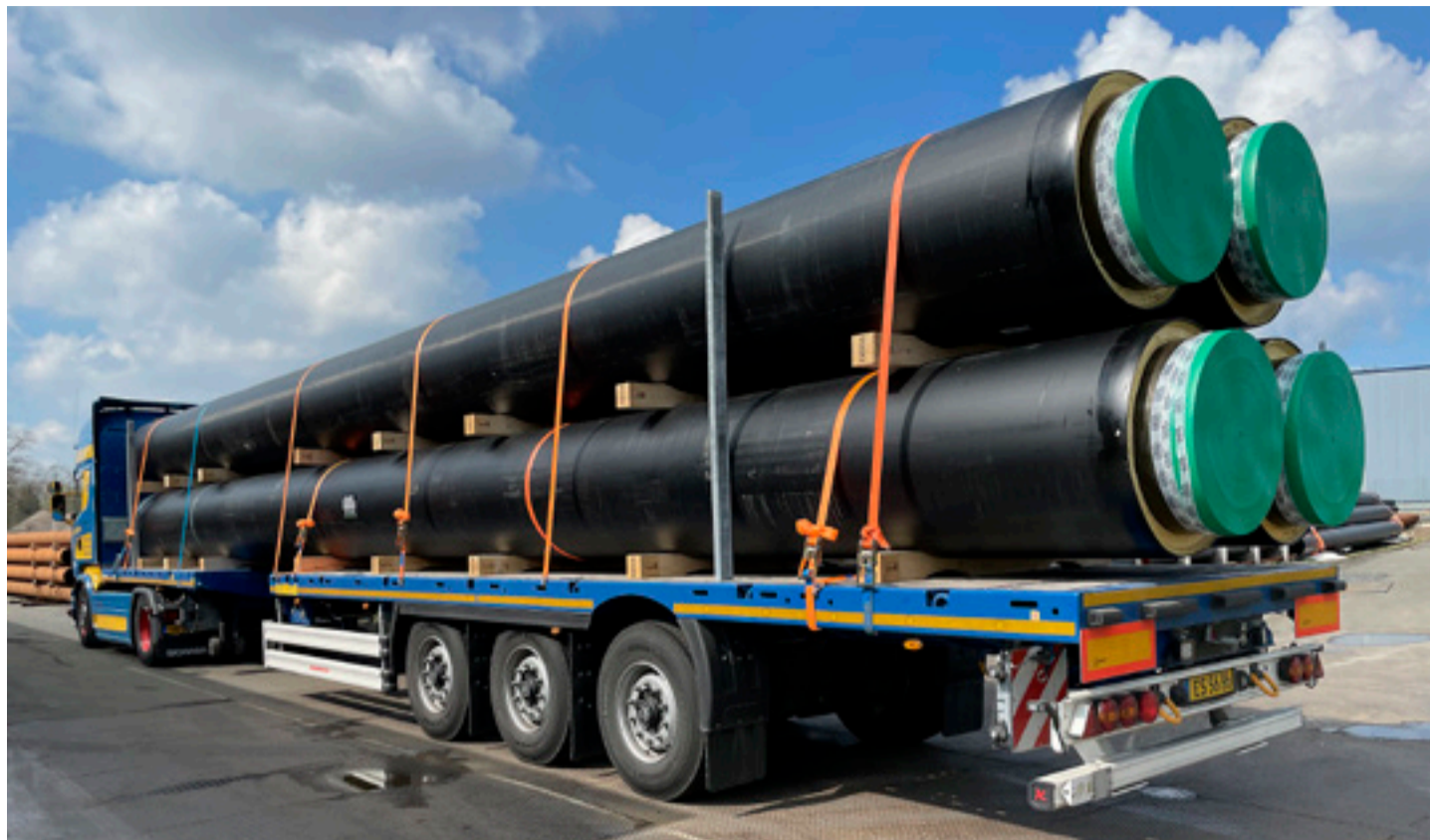
■ Einangraðar 800 mm stálpípur í 1.000 mm plasthlífðarkápu við verksmiðju Set Pipes í býskalandi.
