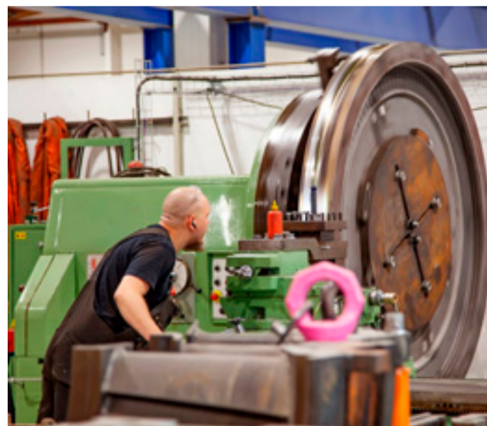
■ Mikil og sérhæfð þekking hefur byggst upp hjá HD í þjónustu við orkuiðnaðinn og ekki síður sérhæfður tækjabúnaður. Hér eru unnið með búnað úr túrbínu í rennibekk fyrirtækisins sem er jafnframt stærsti málmrennibekkur landsins.
