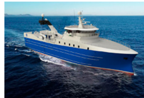
■ Ferskisktogari fyrir borbjörn í Grindavík er í smíðum á Spáni. Skipið verður 58 metra langt og verður mögulegt að breyta því í frystiskip ef á þarf að halda.
