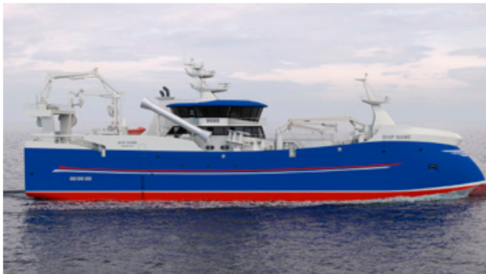
■ Nautic hefur að undanfögnu unnið að hönnun nýrrar kynslóðar uppsjávarskipa. Líkt og sjá má þá ber skipið hönnunareinkenni fyrirtækisins hvað stefnislagið snertir.
