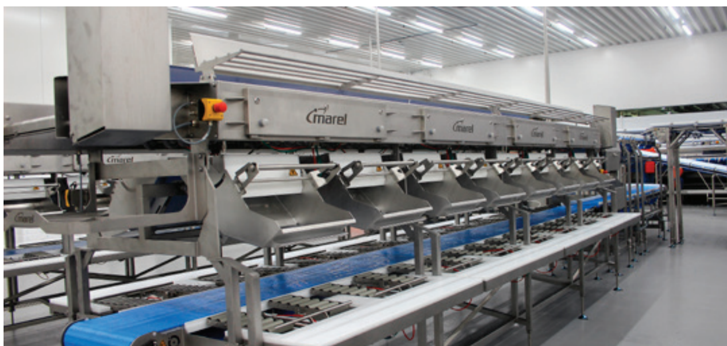
■ Samvalsbúnaður fyrir pökkun á ferskum afurðum. Tölvukerfið að vaki vinnslunni sér til þess að velja saman afurðir af mikilli nákvæmni í þyngdum. Þegar mikið magn er framleitt á árs grundvelli, líkt og í vinnslu G.Run, þá skiptir þessi nákvæmni miklu máli.
