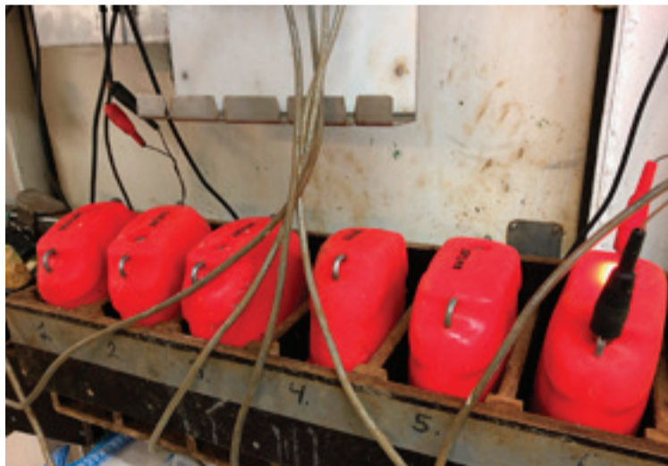
■ Veiðarfæranemarnir í Örfirisey eru frá norska fyrirtækinu Scanmar. Bæði eru þeir á vörpunni sjálfri, sem og á toghlerunum og þannig getur skipstjórinn fylgst nákvæmlega með hvernig opnunin er á trollinu og hvernig það liggur í sjó.
