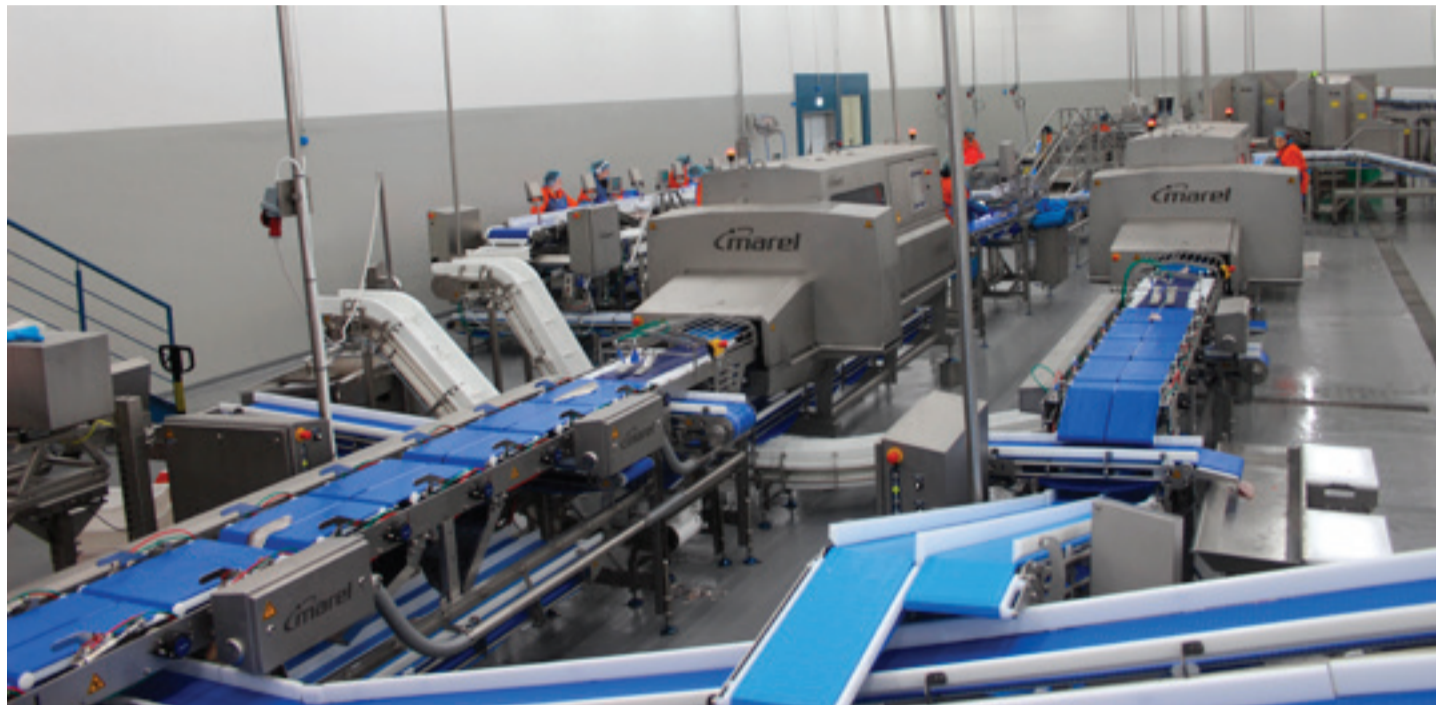
■ Í vinnslusalnum. Hér sjást FleXicut skurðarvélar frá Marel, ein á hvorri vinnslulínu hússins. Nýja vinnslan er að því leyti frábrugðin flestum öðrum að í húsinu eru tvær vinnslulínur, þ.e. önnu fyrir bolfisk og hin fyrir karfa.
