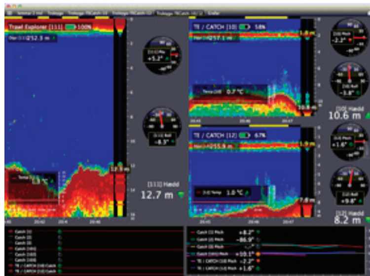
■ Gluggarnir til hægri sýna mynd af tveggja trola rækjuskipi, efri lína er netið og neðri er botninn undir pokanum. Hægt er greina virkni skiljunnar ásamt því ef pokinn dettur á botninn.
