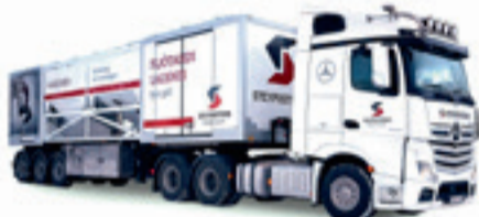
■ Steypustöðin er með góðan tækakost, t.d. sérsmíðaðan flotvagn sem kemur með efnið á staðinn og hrærir efnið í rauntíma. Eingöngu er greitt fyrir það efni sem er notað.
