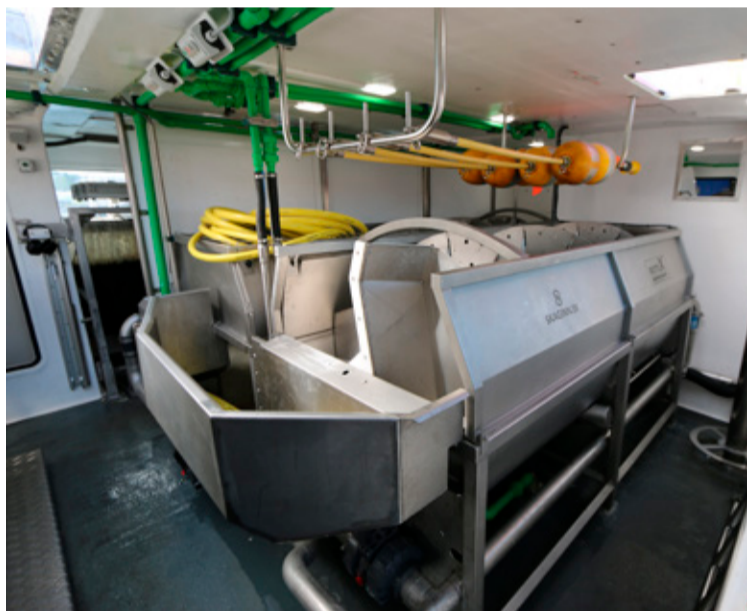
■ Á milliþilfari eru blóðgunar- og kælitankar frá Skaganum 3X. Ís- og kælikerfi er frá Kapp ehf.
